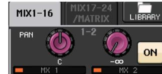
È possibile collegare i parametri principali dei due bus MIX/MATRIX adiacenti con numerazione pari/dispari. Se il bus MIX/MATRIX di destinazione della mandata è impostato su stereo, la manopola sinistra delle due manopole adiacenti TO MIX/MATRIX SEND LEVEL (A LIVELLO MANDATA BUS MIX/MATRIX) viene utilizzata come manopola TO MIX/MATRIX PAN (A PAN MIX/MATRIX) (se nella finestra TO STEREO/MONO è stata selezionata la modalità BALANCE, verrà utilizzata come manopola BALANCE (BILANCIAMENTO)).
