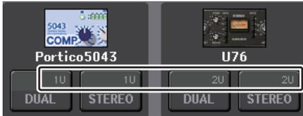
Il tipo U76 occupa due unità di spazio rack. Gli altri processori occupano una unità di spazio rack. Se si monta un processore Premium Rack da due unità di spazio nel rack, non sarà possibile montare alcun altro processore sotto a tali unità di spazio rack. Non è inoltre possibile montare un processore da due unità in rack con numeri pari.
