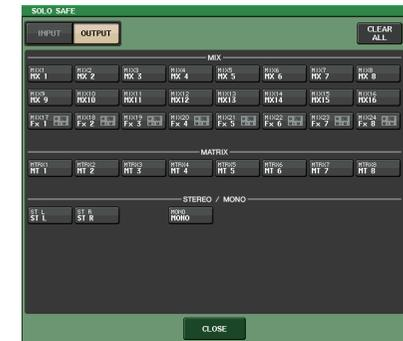
In quest'area è possibile specificare i canali che verranno esclusi dalle operazioni Solo. (è possibile selezionare più canali). I canali selezionati in questo campo non verranno esclusi quando viene attivata la modalità SOLO. Conviene utilizzare questa funzione se, ad esempio, si desidera evitare che determinati canali vengano accidentalmente impostati in modalità SOLO, ad esempio i canali STEREO principali o i canali MIX che inviano i segnali a un registratore esterno.
