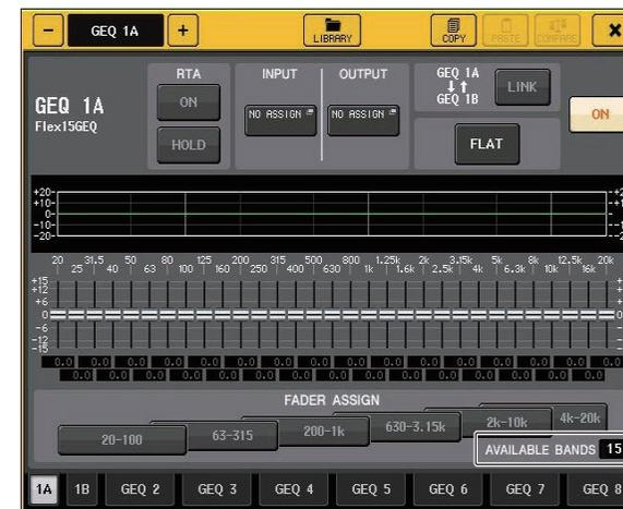
Questa finestra è identica a quella dell'unità 31BandGEQ, fatta eccezione per la casella dei parametri AVAILABLE BANDS che indica il numero in tempo reale di bande aggiuntive (massimo 15) che possono essere controllate nell'unità GEQ corrente. Per un rack in cui è montata un'unità Flex15GEQ, i tab di selezione rack sono suddivisi in xA e xB (dove x è il numero del rack).
