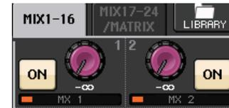
La manopola TO MIX SEND LEVEL viene visualizzata nello stesso colore della manopola corrispondente nella sezione SELECTED CHANNEL. In questo caso, è possibile utilizzare la manopola corrispondente dalla sezione SELECTED CHANNEL per regolare il livello di mandata.
