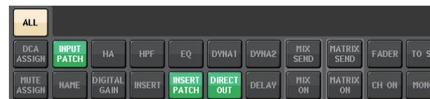
Questa figura indica che i parametri INPUT PATCH, INSERT PATCH e DIRECT OUT sono stati impostati su Safe mediante le impostazioni del parametro Global per INPUT PATCH.
