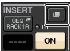
10. Pressione o campo INSERT mais à direita do pós-fader na tela INSERT/DIRECT OUT 1ch.
