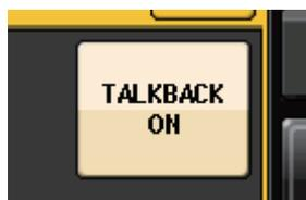
6. Pressione o botão INPUT TO TALKBACK para selecionar uma entrada. Pressione o botão giratório A.GAIN para ativá-lo e, observando o medidor, use o botão giratório para ajustar o nível.
