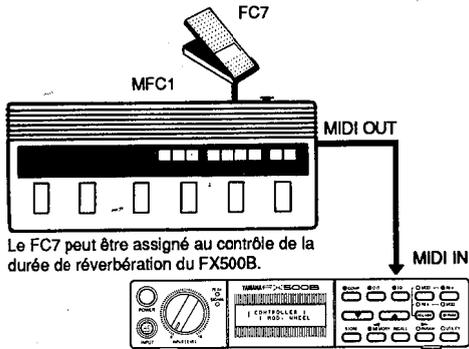
Le FC7 peut être assigné au contrôle de la durée de réverbération du FX500B.
