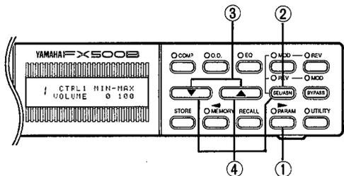
Les numéros de changement de commande suivants et les commandes associées (ou rien si aucune commande n'est spécifiquement assignée) peuvent être sélectionnés:
