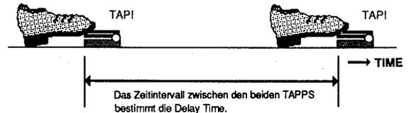
**ACHTUNG:** Wenn der L-DLY oder R-DLY Parameter auf den maximalen oder minimalen Wert eingestellt wird, können Sie die TAP Funktion nicht einsetzen, um längere oder kürzere Tempi anzugeben.
