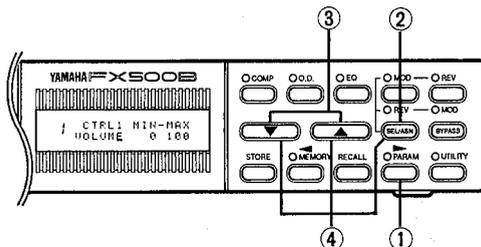
Wenn Sie die beiden Steuerelemente angewählt haben (Controller 1 und Controller 2), können Sie ihnen einen Parameter des FX500B zuordnen. Dies geschieht im PARAM Modus.
