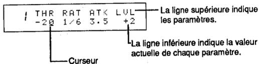
Le mode PARAM ne peut être sélectionné directement à partir du mode UTILITY en enfonçant la touche PARAM. Il faut au préalable sortir du mode UTILITY en appuyant plusieurs fois sur la touche UTILITY ou en la maintenant enfoncée pendant environ 1 seconde, jusqu'à ce que le témoin de cette touche s'éteigne.
