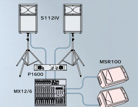
フロアモニターが不可欠なライブや音楽イベントでは、フロア設置にも対応するMSR100がフォールドバックとして活躍します。MSR100はアンプ内蔵タイプなので、モニター用のアンプは不要。ケーブルを接続するだけのシンプルな結線で、モニターシステムを構築できます。しかも、ボディには損傷に強く軽量のポリプロピレン樹脂を採用しており、頻繁なセッティング・撤収作業にも優れた可搬性・耐久性を發揮します。
