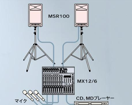
複数のマイクを用い、CDプレーヤーや電子楽器などを使用するイベントなどでは、最大8本のマイクが接続でき、デジタルエフェクターやステレオGEQを搭載したコンパクトミキサーMX12/6を中心としたシステムがおすすめ。シンプルな機材と結線で、100W+100WのSRシステムが構築できます。さらに、スピーカースタンドSTS-50を取り付ければ、オープンなスペースでも充分なサービスエリアを確保できます。
