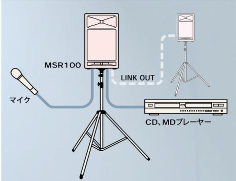
MSR100は、マイクの直接入力可能なマイク(-50dB) / ライン(+4dB)対応の入力端子を装備し、3系統の入力それぞれにレベルコントロールが可能。小規模なイベントや集会などでマイク1本とBGMがあれば充分という場合には、マイクやCDプレーヤーなどを直接入力するだけで、高品位なサウンドを手軽に提供できます。さらに、リンクアウト端子によるスピーカー増設で、広いスペースにも容易に対応できます。
